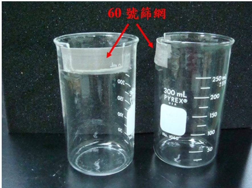
圖二 300 mL 試驗容器示意圖 (篩網以下之容量約為 275 mL)
