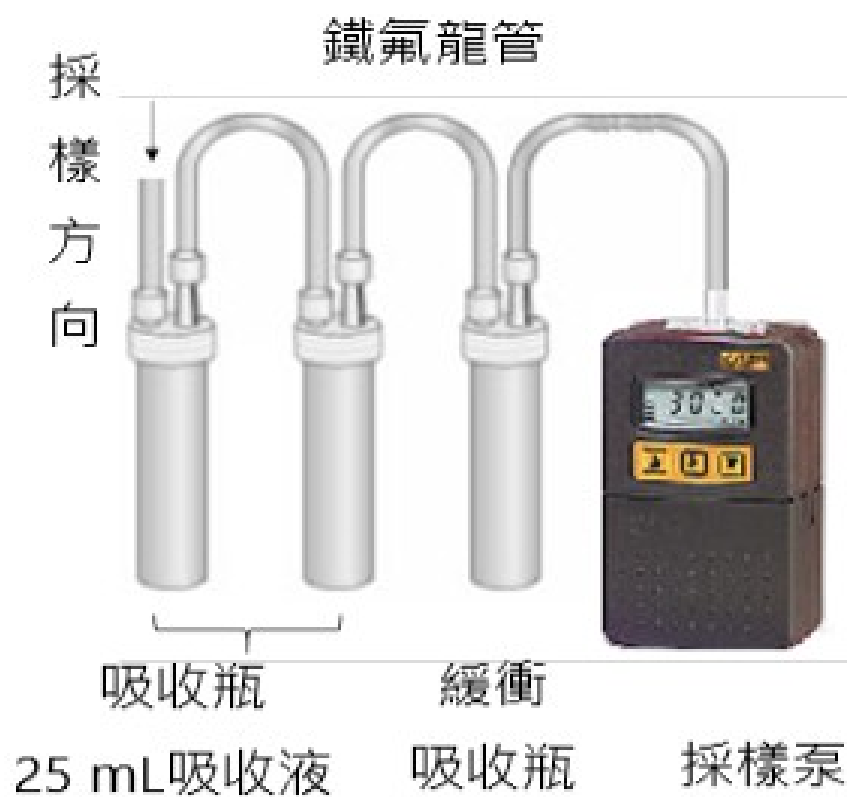
圖一 採樣設備配置圖
