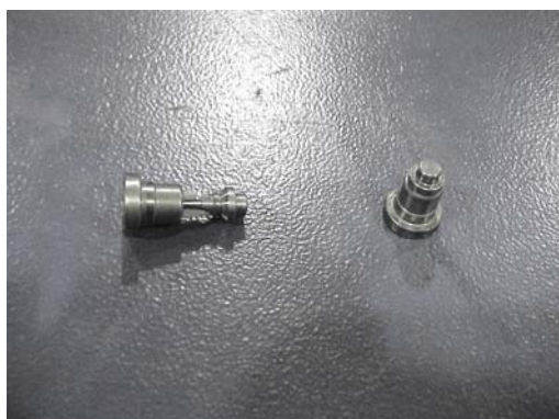
圖 3.4(c) 磨損的輸油閥(在伸縮處會有磨耗)
