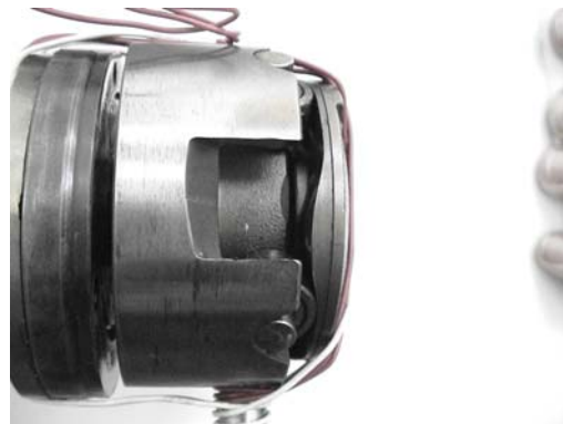
圖 3.4(b) 凸輪盤與供油 PUMP 軸的組合圖
