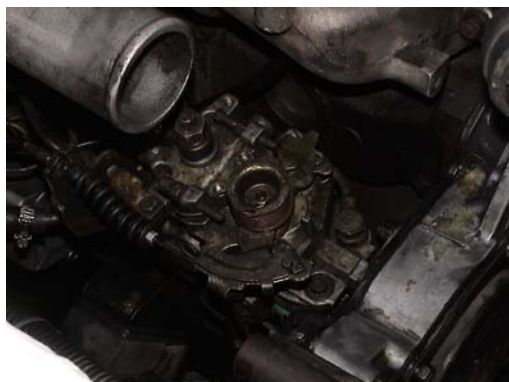
圖 3.4(e) 噴射泵與引擎的組合圖
