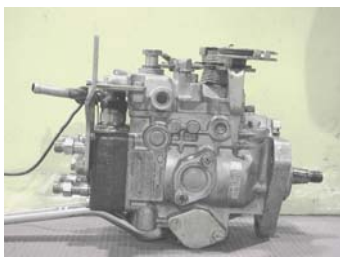
圖 2.2 Diesel KiKi NP-VE4/10F2150RNP145 噴射泵
