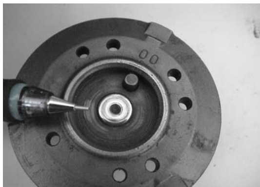
圖 3.4(a) 劣化磨損的凸輪盤之傳動接頭
