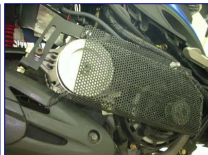
圖 11 發電機實車配置圖
