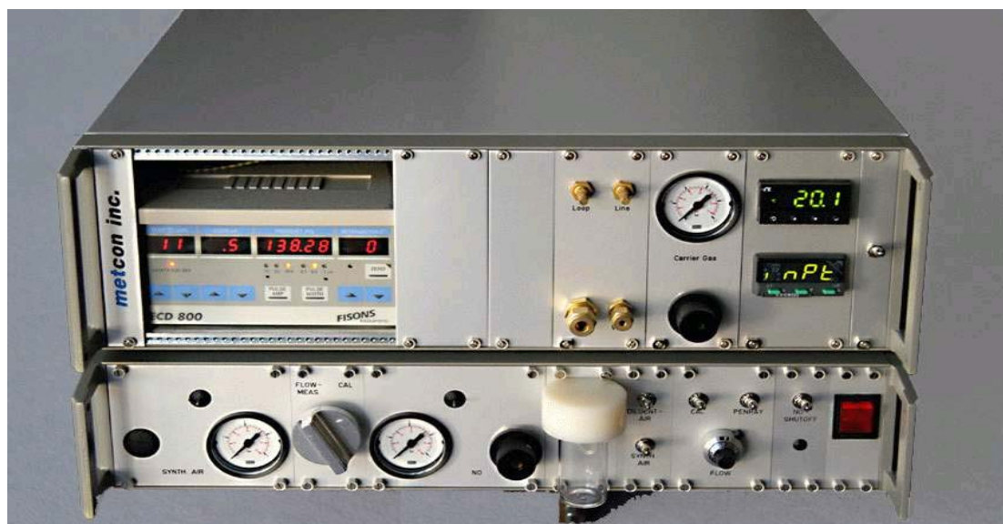
圖 1 PAN GC 自動監測儀（包括標準品製備及層析檢測部分）
