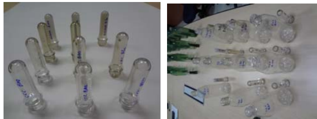
圖 4. 不同三層瓶結構及 B 層料量成型之瓶胚由左而右 B 射出行程 20, 40, 60mm，由前到後 CCC, CRC, RRR, CAC 三層瓶。
