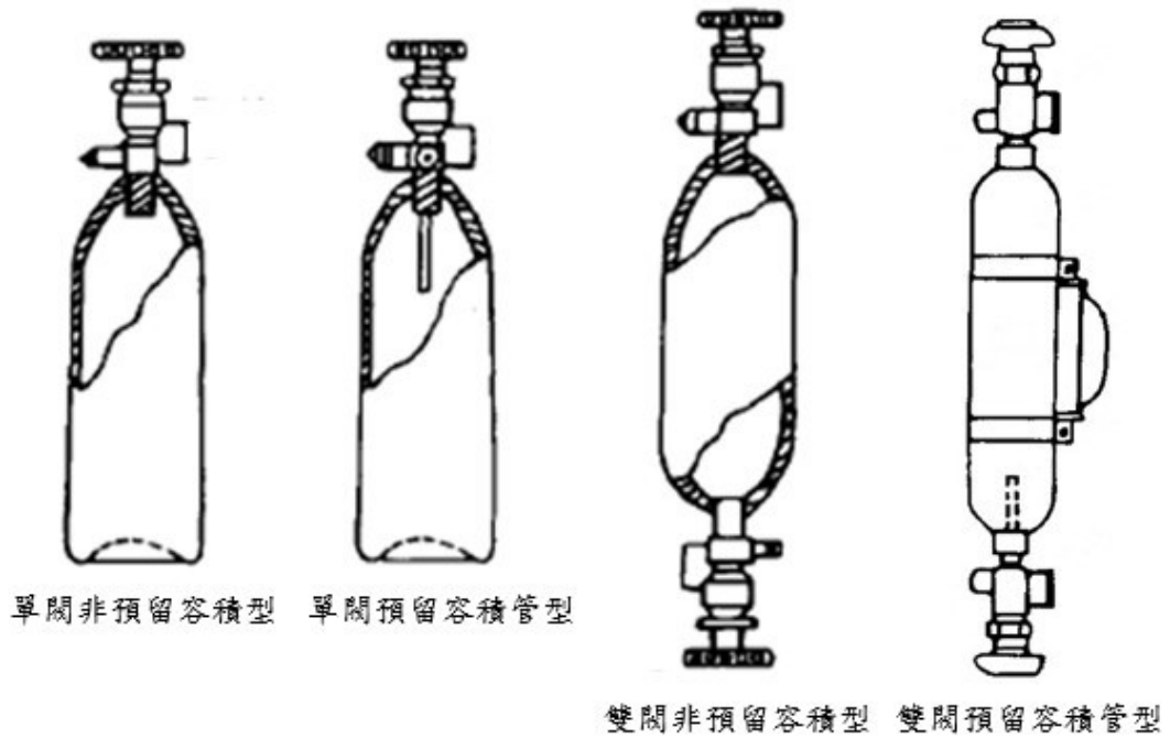
圖三 氣體鋼瓶類型（單閥非預留容積型、單閥預留容積管型、雙閥非預留容積型、雙閥預留容積管型）
