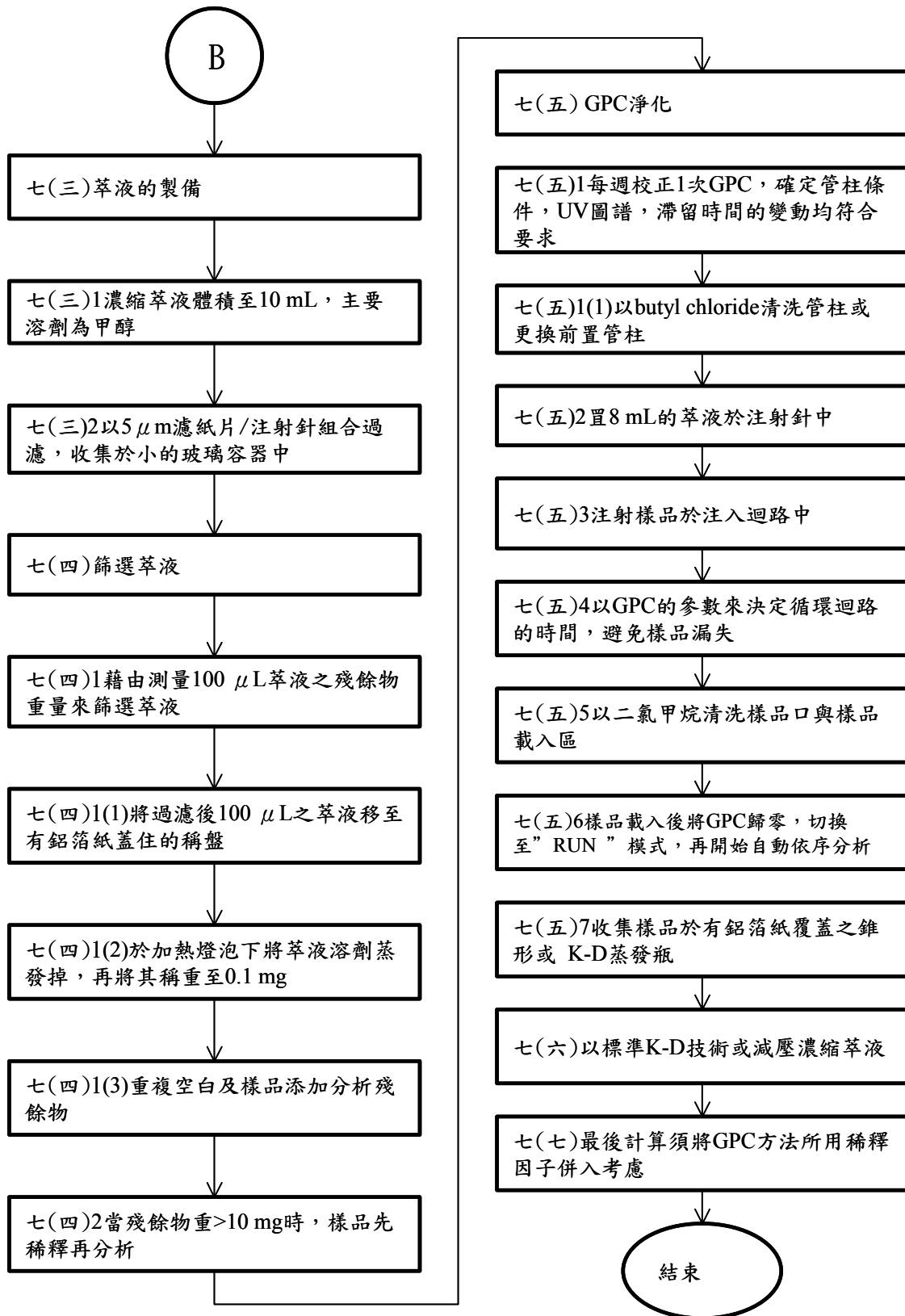
圖三 膠滲透淨化流程圖（續）
