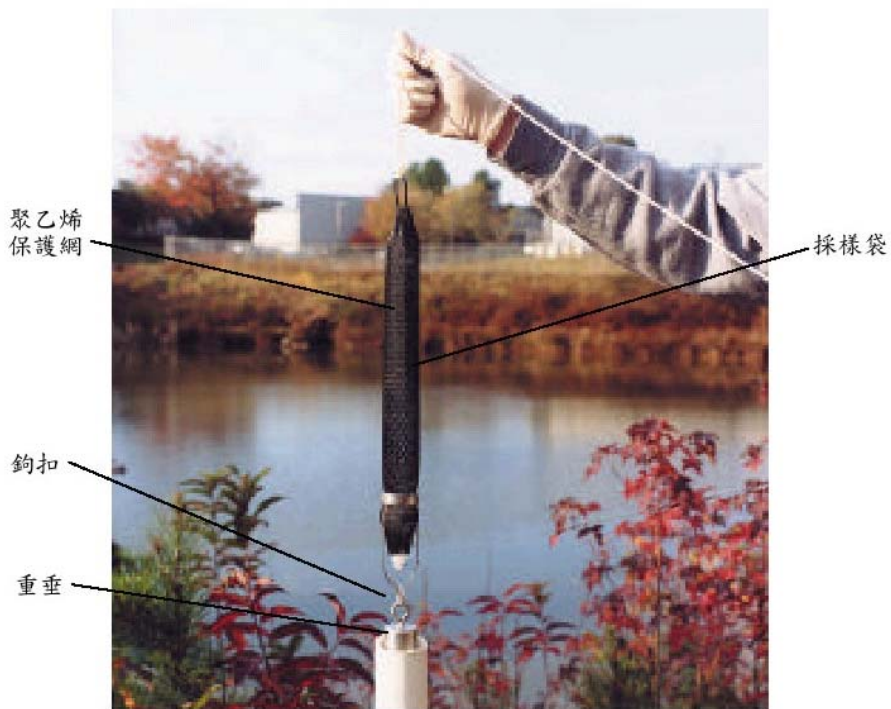
圖二 監測井地下水被動式揮發性有機物被動式擴散採樣袋採樣圖
