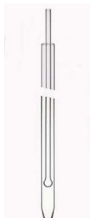
圖三 液體採樣管示意圖
