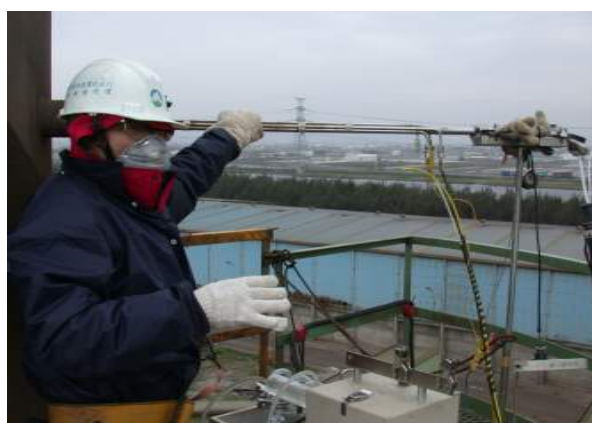
圖 2：執行焚化爐煙囪排放戴奧辛採情形，採樣管經傳輸線連結採樣箱（內含吸收排氣中氣狀戴奧辛之吸附劑 XAD-2 及吸收排氣中粒狀戴奧辛之濾紙）經圖 1 主機等速吸引約 3 小時以取得焚化爐戴奧辛樣品。
