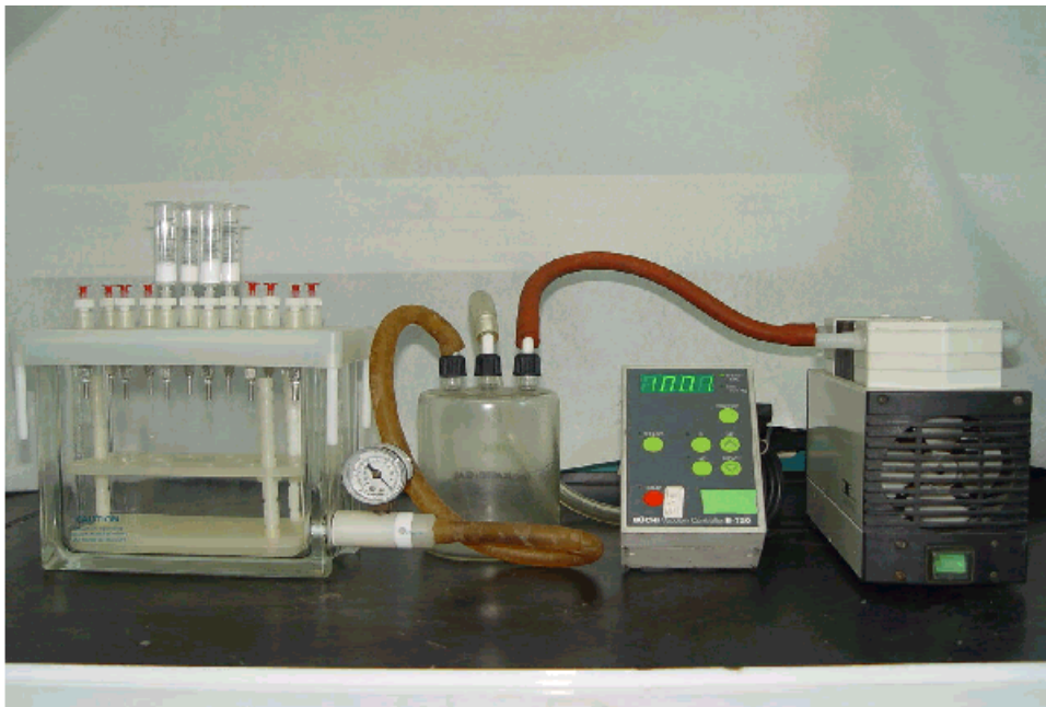
圖三 手動固相萃取管 (Cartridge) 萃取裝置
