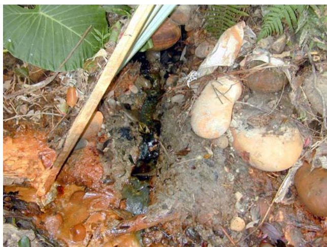
圖 3 污染地點之水源伴隨黑色浮油(污染發現點為距離加油站約二百公尺之陡峭坡坎處，黑色浮油隨山泉水自壁間湧出)
