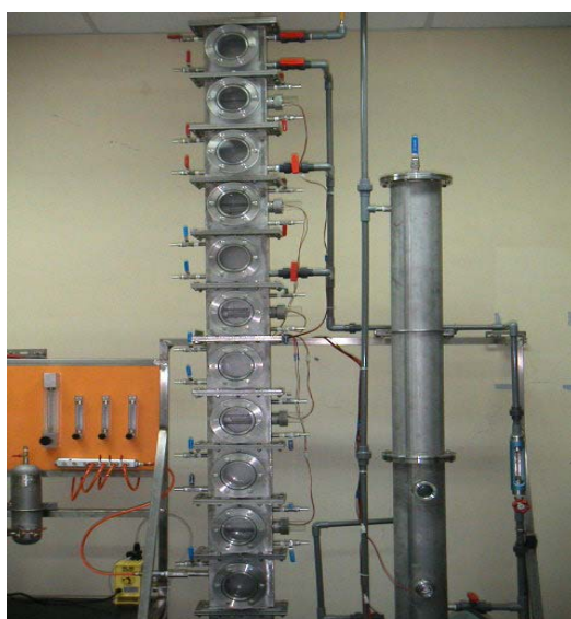
圖 5-3 UV/H 2 O 2 化學洗滌設備圖
