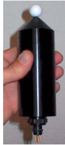
圖一、不同型式的可見光光強度偵測計。(A) 美國某公司生產之平面式偵測計；(B) 美國某公司生產之半球形式偵測計；(C) 英國某公司生產之球形式偵測計。
