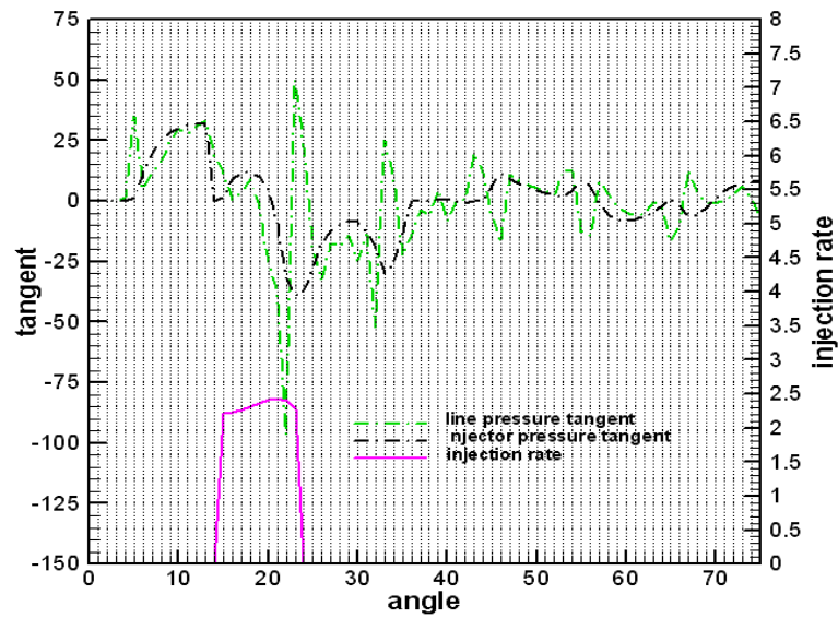
圖 13 高壓油管(x=0.45)壓力上升率,噴油嘴壓力上升率與噴射率隨曲軸角的關係圖,2000rpm
