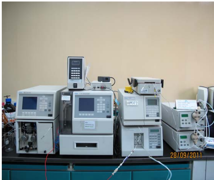
高效能液相層析儀：以親合力差異等原理，檢測環境用藥是否含有禁止添加的毒性物質
