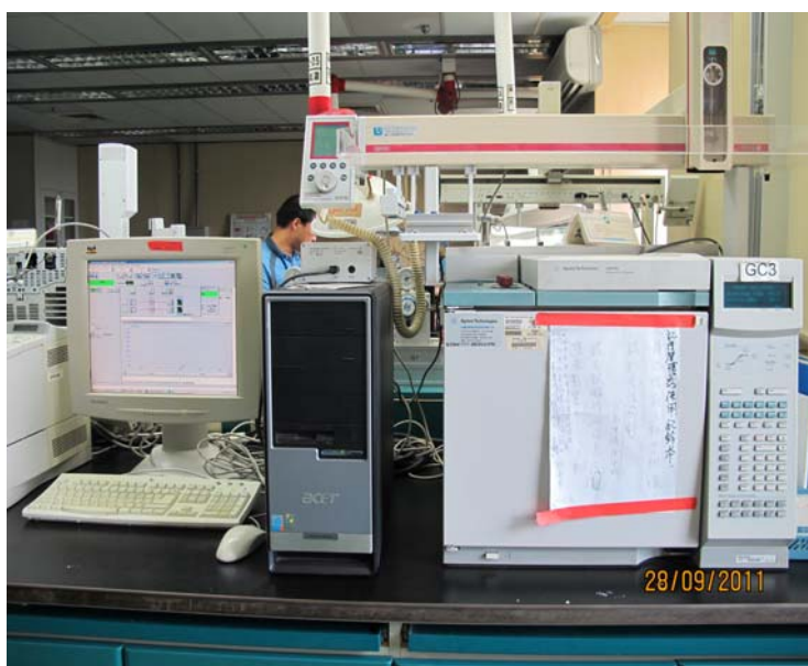
氣相層析儀：使物質氣態離子化後偵測其及帶電量多寡來檢測環境用藥是否含有禁止添加的毒性物質
