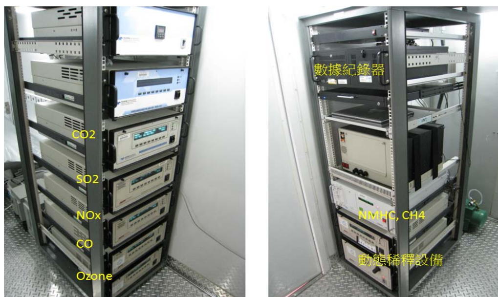
圖 2 空氣品質監測車之內部儀器配置，內部配置多種污染物監測儀器及數據收集系統
