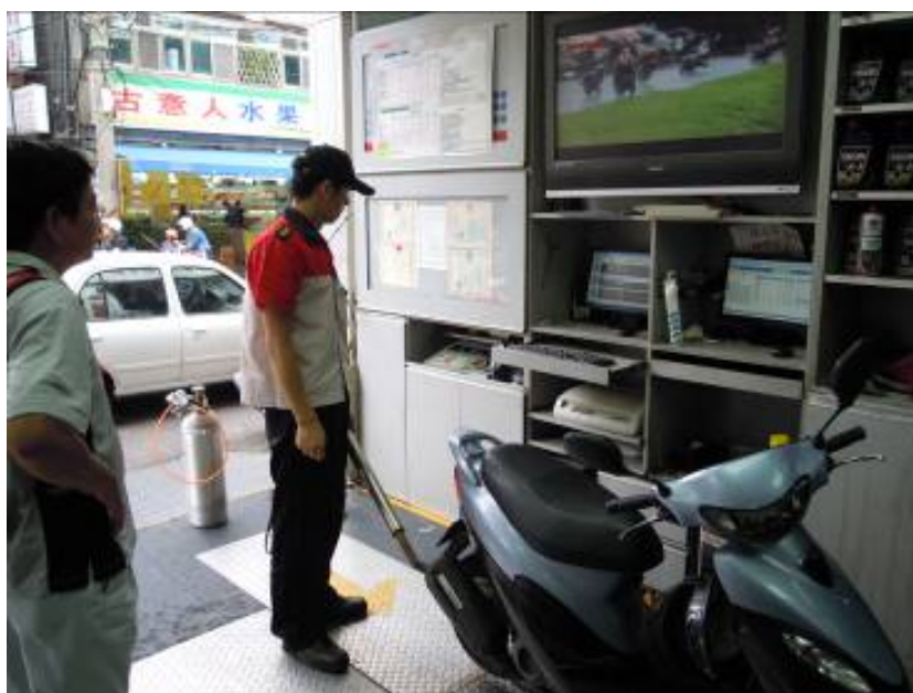
圖 4：機車族到住處附近機車排氣檢驗站接受排氣檢測情形，現行環保署公告機器腳踏車排氣管排放標準為：一氧化碳(CO)4.5 %、碳氫化合物(HC) 9000 ppm，機車排氣超出標準則必須改善後再複驗。
