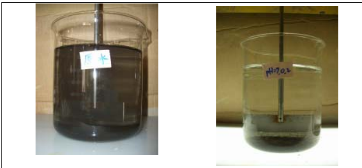
圖 4.15：灰水未加混凝劑與添加最適量混凝劑之澄清效果比較
