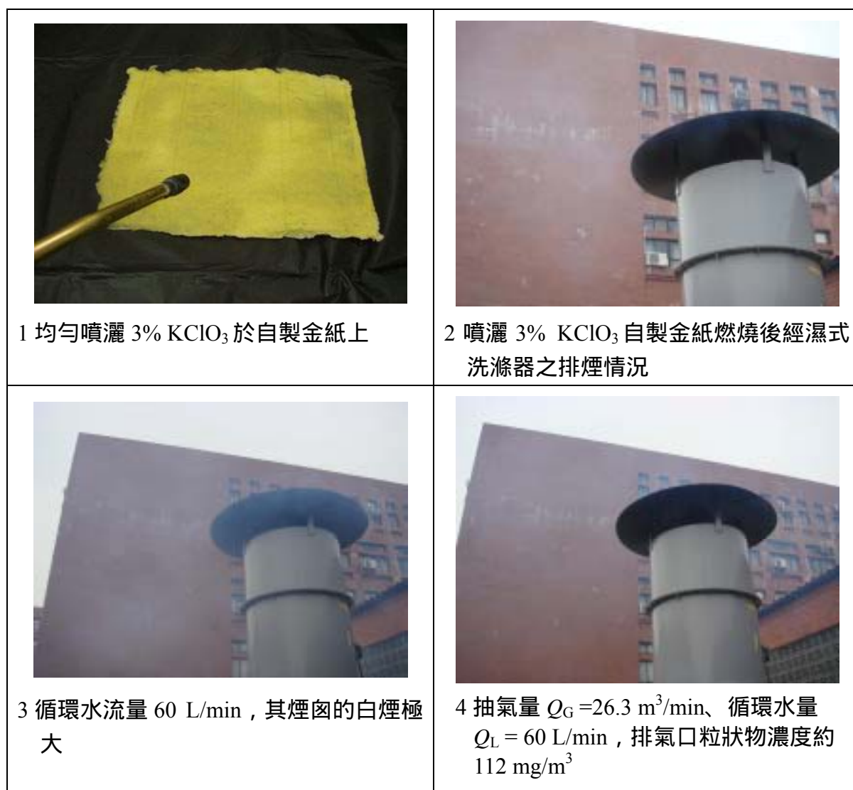
圖 4.13：噴灑 3% \text{KClO}_3 自製金紙之燃燒排氣洗滌情形
