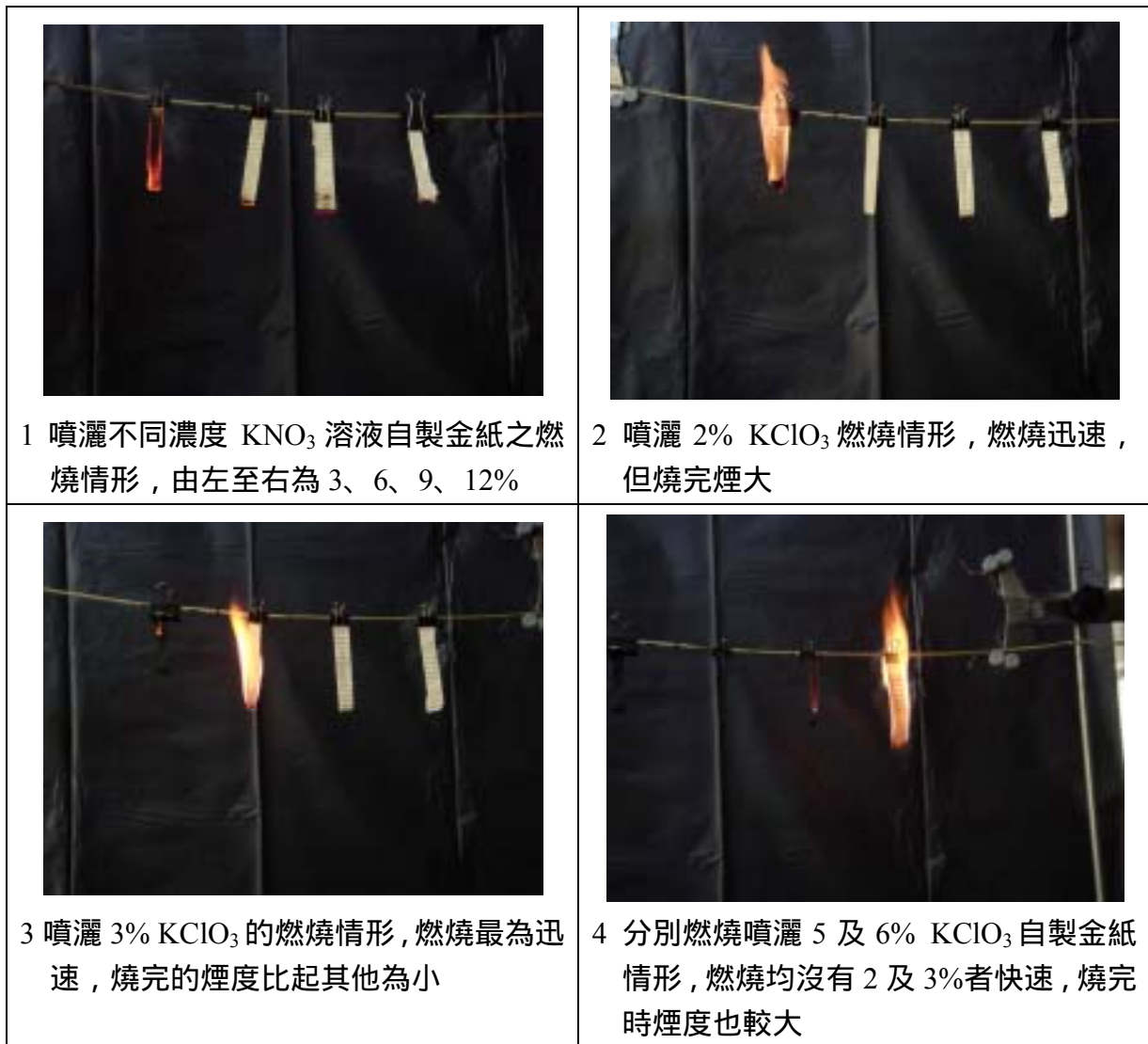
圖 4.12：比較添加不同濃度 \text{KClO}_3 助燃劑自製金紙之燃燒情形
