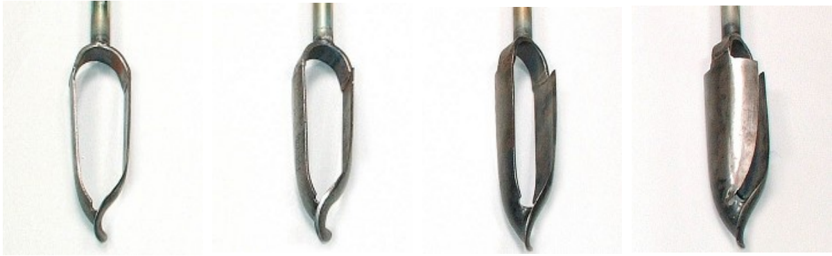
黏土用愛德曼(Edelman)土鑽(適於黏性土壤) 綜合用愛德曼土鑽(適於中性黏質土壤) 砂用愛德曼土鑽(適於黏性砂質土壤) 粗砂用愛德曼土鑽(適於較鬆或非常乾土壤)
