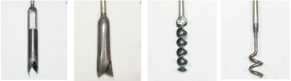
Riverside 型式土鑽(適於硬土壤或混合之細石礫之土壤層) 含石頭土壤用土鑽(適於土壤含大礫石) 堅硬土層用土鑽(適於較深堅硬土層) 移除石頭用鉤具(適於已鬆脫石頭)
