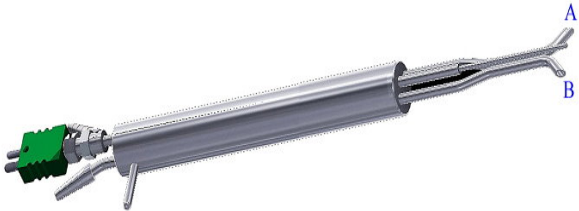
圖一 典型的 Type S 皮托管
