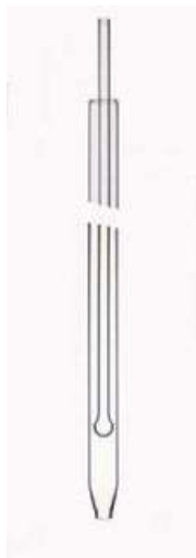
圖三、液體採樣管示意圖
